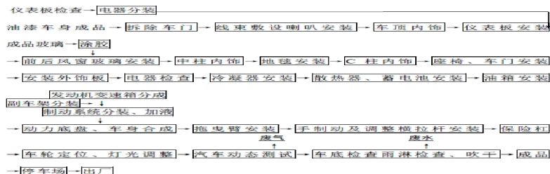
图 4 总装车间生产工艺流程及产污环节图
